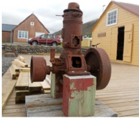
Glóðarhausvél með einum strokk. Sjáid tappan í hjólinu inn dreginn. Glóðarhausvélin í Freyju var tveggja strokka og mun stærri en þessar.
