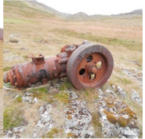
Glóðarhausvél með einum strokk. Sjáid tappan í hjólinu inn dreginn. Glóðarhausvélin í Freyju var tveggja strokka og mun stærri en þessar.
