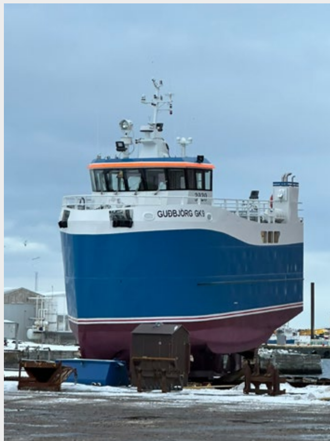
Guðbjörg GK 9 er 13 metra langur stál- og álbatúr, hannaður af Ráðgarði Skipa-ráðgjöf. Smiðin fór að mestu fram í Tyrklandi en Skipasmiðastöð Njarðvíkur rak smiðshöggjið á verkið. Báturinn kom til landsins í október 2023 og hét þá Margrét GK 9.
