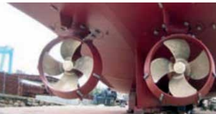
Azimuth skrúfu- og stýrisbúnaður dráttarbáts sem hægt er að snúa 360°.
