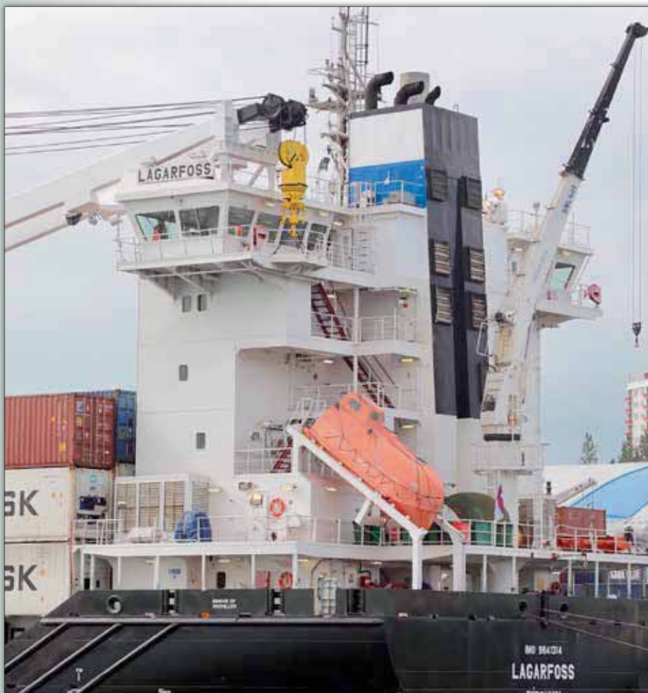
Skorsteinn Lagarfoss hækkaði umtalsvert við að koma opnum útblátunarhreinsibúnaði fyrir í skipinu.
