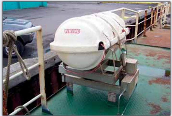
Olsen 003 losunar og sjósetningarbúnaður dekkgálgi einnig notaður á stýrishúspaki.
