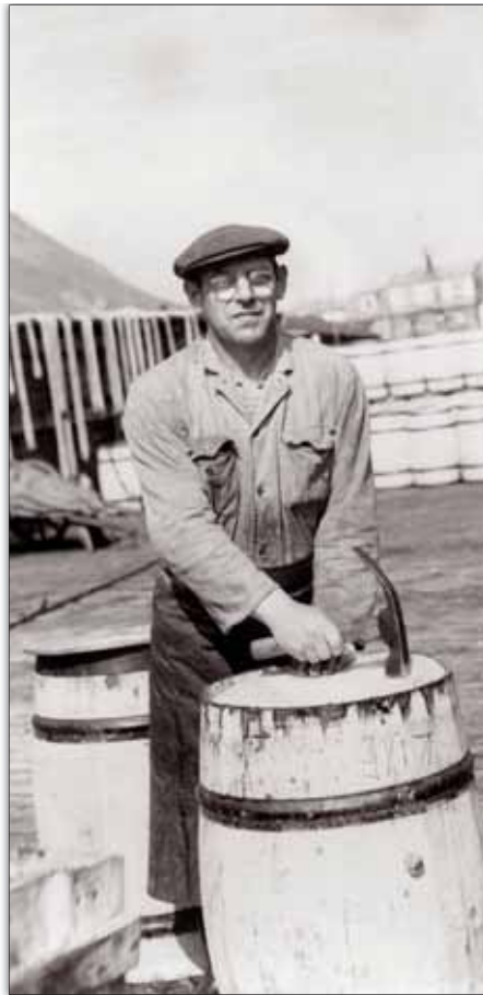
Dixilmaður á Siglufirði. Verkfærið sem maðurinn sveiflar nefnist dixill og var notað til að slá til sildartunnur og opna þær. Myndin er tekin á 20. öld. Á dögum Snorra Pálssonar hefur embætti dixilmanns líkast til kallast beykir.
